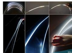
光技術ベンチャー企業であるSOLAR OPTICSは、プラスチック光ファイバーの超精密加工を通じて、高輝度側面発光型光ファイバーの試作品を開発したと発表しました。（中略）ソーラーオプティクスが開発したプラスチック光ファイバー（O.S.L. Optical Fiber Side Lighting）は、従来のガラス光ファイバーが持たない価格競争力を確保し、従来のプラスチック光ファイバーの低い輝度問題を解決し、高輝度側面発光を実現した技術です。
